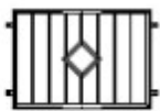
Zierelement Z3 Rahmen Rohr D=33,7 mm Füllstäbe Rund D=10 mm Zierrahmen Rohr D=26,9 mm ohne Füllung im Zierelement
