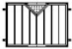
Zierelement Z2 Rahmen Rohr D=33,7 mm Füllstäbe Rund D=10 mm Füllung Blech 2 mm
