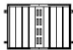
Zierelement Z5 Rahmen Rohr D=33,7 mm Füllstäbe Rund D=10 mm Füllung Blech 2 mm
